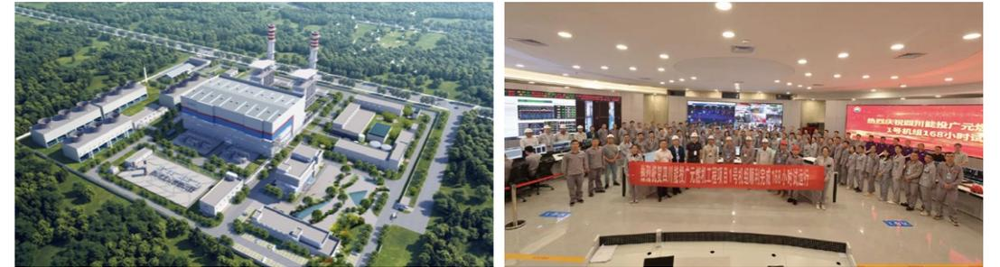
四川能投广元燃机工程建设2套高效、清洁的“9H级”燃气-蒸汽联合循环发电机组，装机容量为2×700MW。采用的“9H级”燃气轮机是目前世界上功率最高、效率最高的重型燃气轮机。项目建成投产后，年发电量将达35亿kM/h，将有效改善四川省电网调峰能力，优化电源结构，提升电网供电可靠性。
