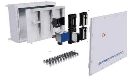
科远智慧自主研发的SyncSIO产品, 采用无源光总线技术, 将整体防爆认证的I/O信号采集前端通过光纤形式传输到系统中。防爆I/O箱拥有Ex ec nC IIC T4一体化认证, 可直接放置于现场防爆II区, 极大程度上减少了信号电缆的长度和机柜间的需求空间, 节省工程投资。SIO机箱采用标准化尺寸设计, 采用多功能IO模块, 降低了控制系统招标对详细设计的依赖程度, 能够大大提前工程的实施进度。在一些控制室距离现场较远、控制点位设计不明确仅有点位数量的项目中有着独特的优势。
