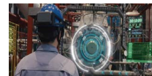
智能头盔对现场风险点 如高温、高电压、高空悬挂物等 的智能识别
