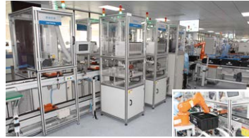
DCS 卡件装配测试生产线
