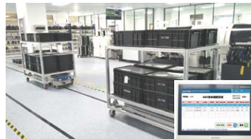
AGV物流运输系统
