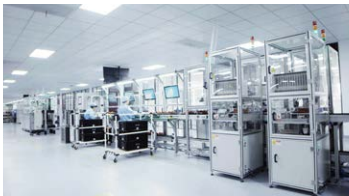
DCS 底座自动装配生产线
