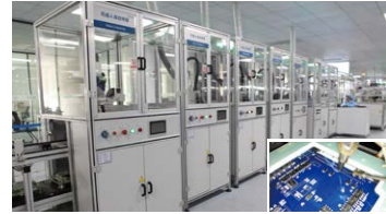
PCBA自动焊接烧录测试线
